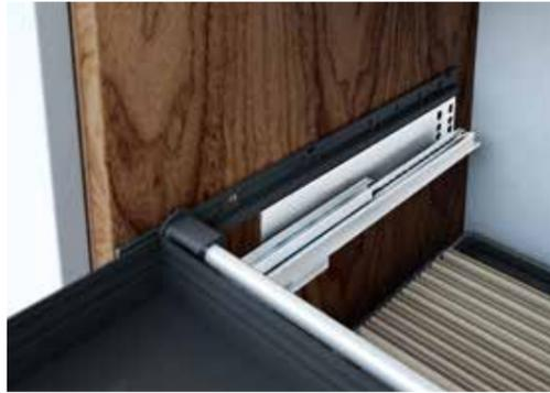
Damit auch schwer beladene Schübe und Hängeregistraturen leicht und verwindungsfrei herausgezogen werden können, ist der Parallellauf der Gleitschienen über eine Zahnstangenführung gewährleistet.
